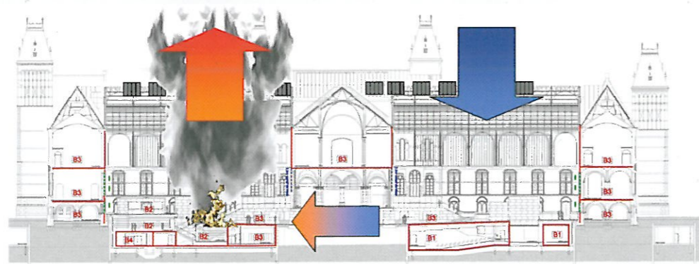
DE ATRIA ZIJN VOORZIEN VAN EEN ROOK EN WARMTE AFVOERINSTALLATIE: BIJ EEN BRAND IN ÉÉN VAN DE ATRIA WORDEN IN BEIDE ATRIA DE DAKLUIKEN OPEN GESTUURD EN WORDT TOEVOERLUCHT VANUIT HET ANDERE ATRIUM AANGEVOERD, WAARDOOR DE ROOK VIA DE DAKLUIKEN WORDT AFGEVOERD.
